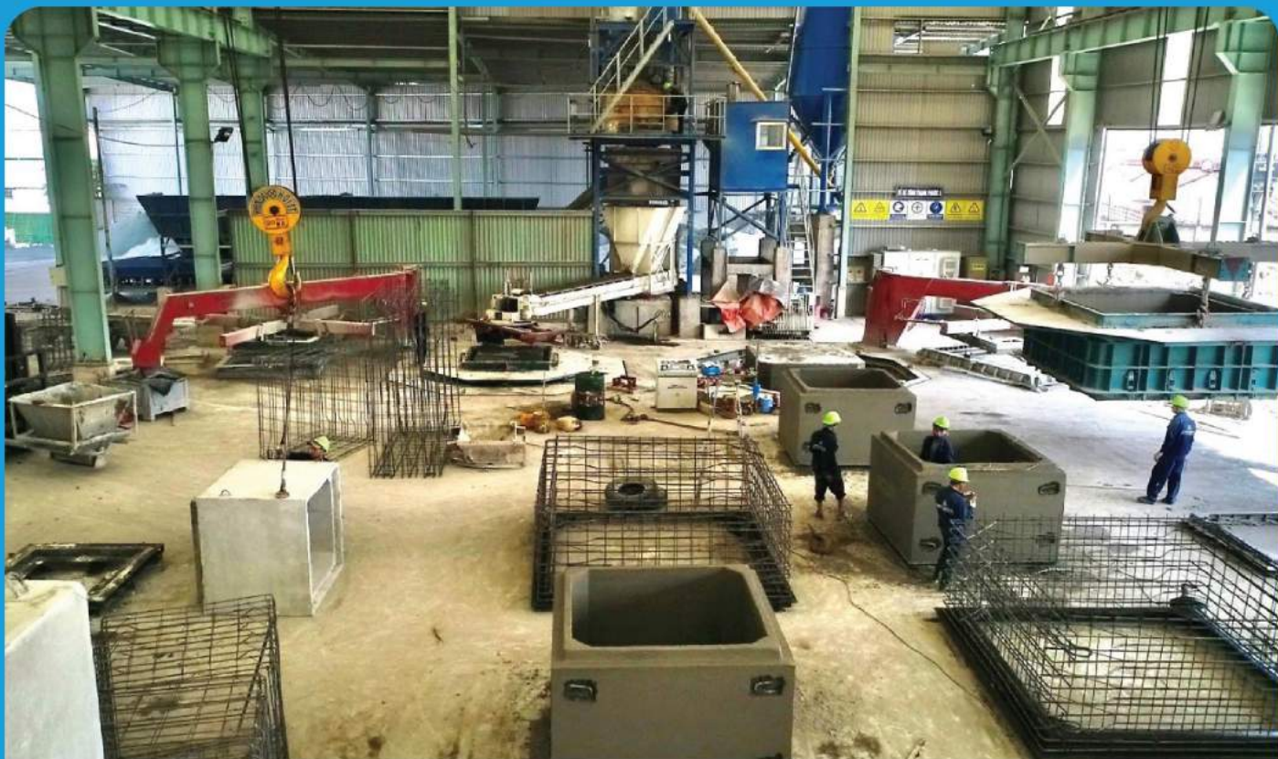
CÔNG HỘP BÊ TÔNG CỐT THÉP RUNG LỖI, RUNG ÉP, VÀ RUNG
